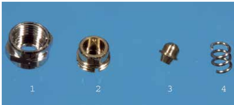
Abb. 463 und 464 Grundsätzlich wäre aufgrund der perfekten Passung eine Führung des Riegels in der Galvanostruktur anzustreben. Aufgrund des geringen Platzangebotes wird der Riegelkasten allerdings gusstechnisch hergestellt und mit der Galvanostruktur verklebt – als Snap-Element wird das MiniPressoMatic der Firma Metalor Dental verwendet. Dieses setzt sich aus dem Gehäuse, der Verschlusschraube, dem Druckbolzen sowie der Feder zusammen (v.li.)
