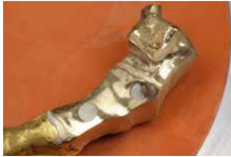
Abb. 487 und 488 Ist der Kleber ausgehärtet werden die Außenflächen nochmals im Fräsgerät mit 0°-Fräsen nachbearbeitet, das heißt, konkret von überschüssigen Kleberresten et cetera befreit. Unserer Tertiärstruktur darf später nichts im Wege stehen. Möglichst plane Flächen sind anzustreben
