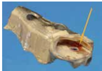
Abb. 476 bis 479 Nach dem Ausbetten, Abstrahlen und Absäuern werden die Riegelblätter mithilfe eines wasserlöslichen Filzstifts in den Kasten eingepasst. Hierzu bestreicht man den gesamten aktiven Teil des Riegelblatts und führt dieses vorsichtig in den Riegelkasten. Störstellen im Kasten werden dadurch präzise sichtbar gemacht und können entsprechend gezielt entfernt werden
