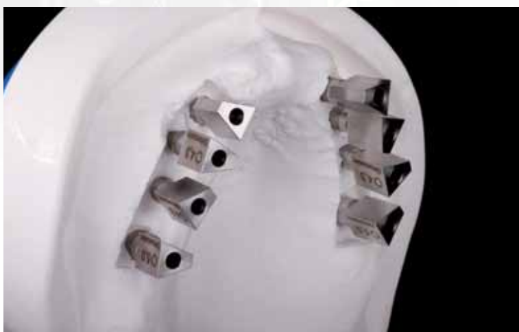
03 Das Implantatmodell wird mit speziellen, mehrfach verwendbaren Scanmarkern aus Titan versehen. Diese helfen der CAD-Software, die exakte Ausrichtung des Implantats zu berechnen
