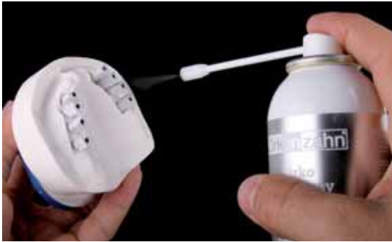
04 Die Marker müssen mit Scanspray eingesprüht werden, um fehlerhafte Reflexionen aufgrund der metallischen Oberfläche zu vermeiden
