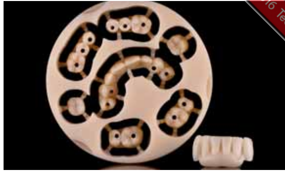
15a + 15b Auf Basis der Konstruktionsdaten der Brückensegmente und der beiden Einzelkronen wurden zunächst Kunststoffprototypen mit dem Fräsgerät M5 angefertigt
