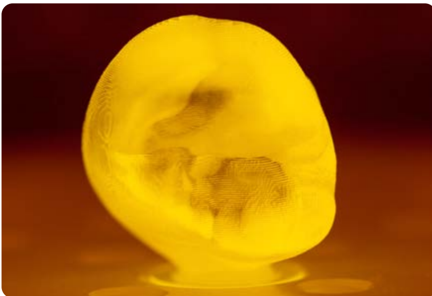
^ Gedruckte Krone während der Polymerisation
