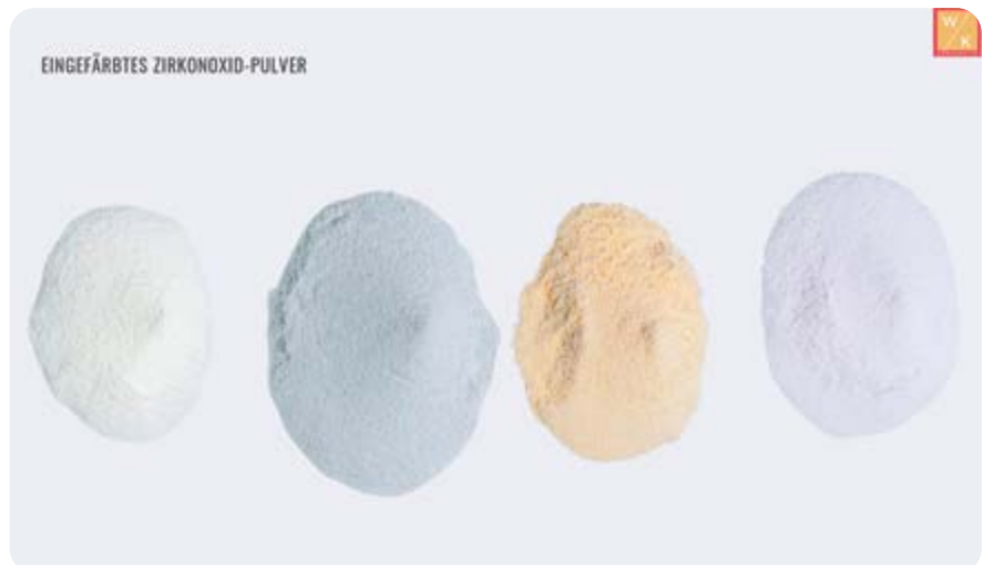
^ 02 Zirkonoxid wird meist aus Pulver (Zirkonium) hergestellt, dem verschiedene Zusätze (zum Beispiel Yttrium) beigemischt werden.
