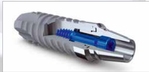
Die Thommen Implantat-Abutment-Verbindung mit Führungsring, der die schlanke Abutment-Schraube vor lateralen Kräften schützt
