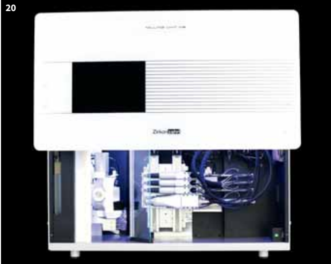
20 + 21 Die einzelnen Brückensegmente und Einzelkronen wurden mit dem 5+1-Achsen-Simultan-Fräsgerät M5 aus Prettau Zirkon gefertigt. In der Software ist eine Funktion implementiert, die Brückenelemente mit einem Sinterfuß zu versehen. Dieser schützt die Strukturen beim Dichtsintern vor Verzug
