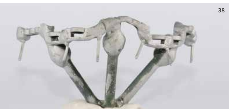
38 & 39 Das aus einer CoCr-Legierung gegossene Gerüst vor dem Abtrennen der Gusskanäle
