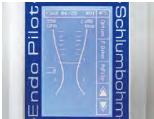
Abb. 1 Der EndoPilot ist Motor, Apexlocator und Obturationssystem in einem. Ein Klick auf das Display zur jeweiligen Feile (hier F360) zeigt alle eingestellten Werte wie etwa Umdrehungsgeschwindigkeit und Drehmoment
