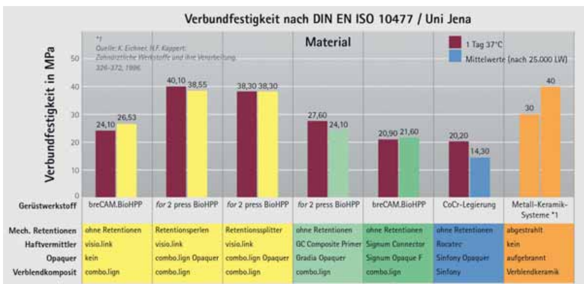
08 Die Verbundfestigkeit zwischen Gerüst und Verblendung ist für den langlebigen Erfolg ausschlaggebend
