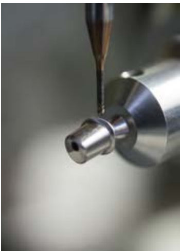
Fräsen eines individuellen Abutments
