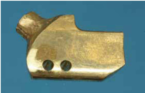
Abb. 586 und 587 Die erste Bohrung wird im geschlossenen Riegelblatt angebracht, die zweite im geöffneten. Die Bohrung in der geöffneten Position bildet den Anschlag, der die Öffnungsbewegung des Riegels begrenzt
