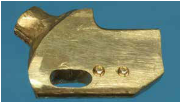
Abb. 592 Das mit der Führungsrille und den Bohrungen versehene Riegelblatt ist nun bereit für die weitere Verwendung
