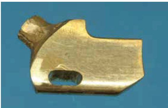
Abb. 588 und 589 Nach dem definieren der beiden Positionen „offen“ und „geschlossen“, werden diese mit einer Hartmetallfräse miteinander „verbunden“
