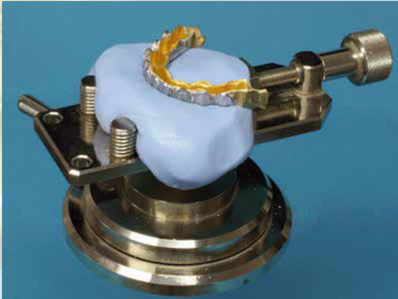
Abb. 579 Bevor wir die beiden Endpunkte anbringen (Riegel offen und geschlossen), wird das Gerüst in einem harten Knetsilikon auf dem Frästisch fixiert und im Fräsgerät ausgerichtet
