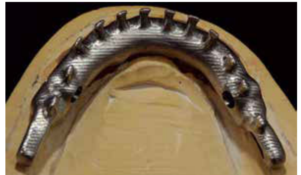
Abb. 25 Neu: Neben der Primärstruktur kann auch das Sekundärgerüst (hier für den Unterkiefer) zentral gefräst werden
