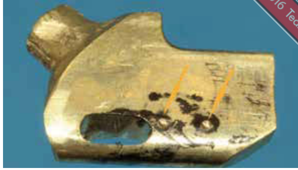
Abb. 591 An den Filzstift-Markierungen (Pfeile) werden nun mit einem 1,2 mm Körnerbohrer die Vertiefungen angebracht
