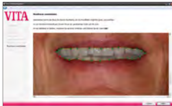
Abb. 7 Um den virtuellen Aufstellungsvorschlag in der Mundhöhle platzieren zu können, wird der Bereich innerhalb der geöffneten Lippen so präzise wie möglich ausgeschnitten. Die kleinen, grünen Rechtecke helfen dabei
