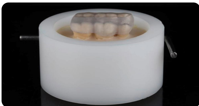
^ 13 3D-gedruckte Teilschiene aufgesetzt auf einem Kieferabschnitt und eingebettet für die Kausimulation.
