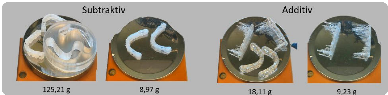
^ 06 Materialgewichte bei der Herstellung einer Schienengeometrie. Links: gefräst („Subtraktiv“) – Rohling und zwei Schienen wiegen 125,21 g, nur die Schienen wiegen 8,97 g. Rechts: 3D-gedruckt („Additiv“): Schienen und Stützstruktur wiegen 18,11 g, nur die Stützstrukturen wiegen 9,23 g.
