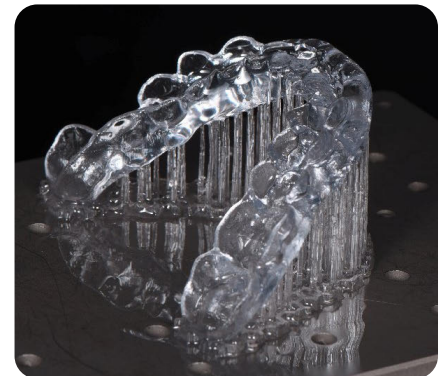
^ 05 3D-gedruckte Aufbisschiene mit Stützstrukturen
