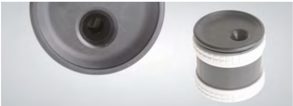
10 + 11 Diesen Deckel setzt man normalerweise nach dem Befüllen der trixpress-Muffel auf. Durch das kleine, exzentrisch angebrachte Loch kann dann der Einbettmasseüberschuss austreten. In der Folge hat man einen glatten und blasenfreien Muffelboden, der nicht komplett getrimmt werden muss
