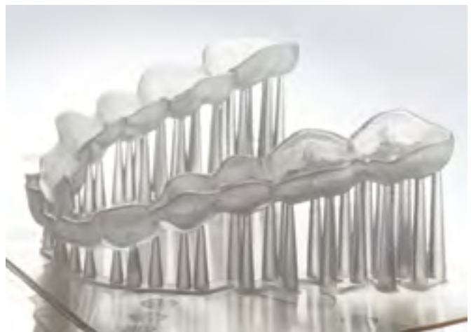
Mit dem Desktop-3D-Drucker Varseo von Bego Medical lassen sich laborseitig diverse Kunststoffstrukturen generieren
