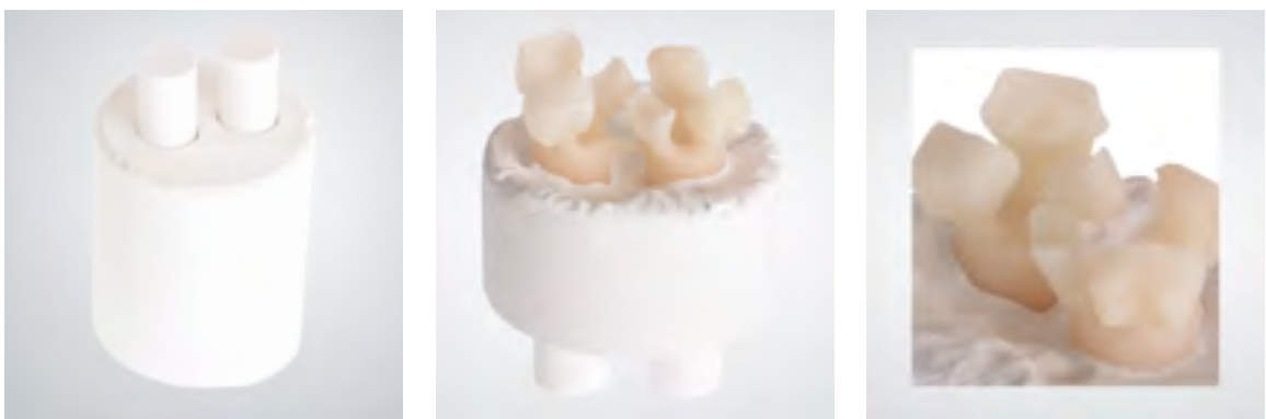
12 In diesem Fall wurde mit zwei Press-Stempeln gearbeitet. Das garantiert eine gleichmäßigere Verteilung des Press-drucks und bessere Pressergebnisse
