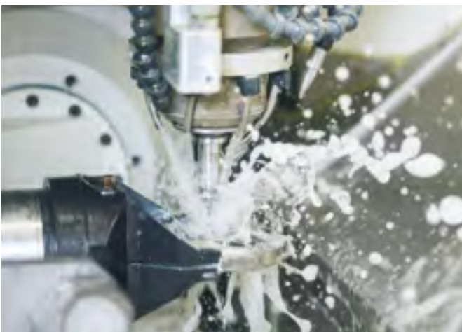
Neben dem SLM kommen bei Bego Medical zur Bearbeitung von EMF-Legierungen auch subtraktive Verfahren zum Einsatz
