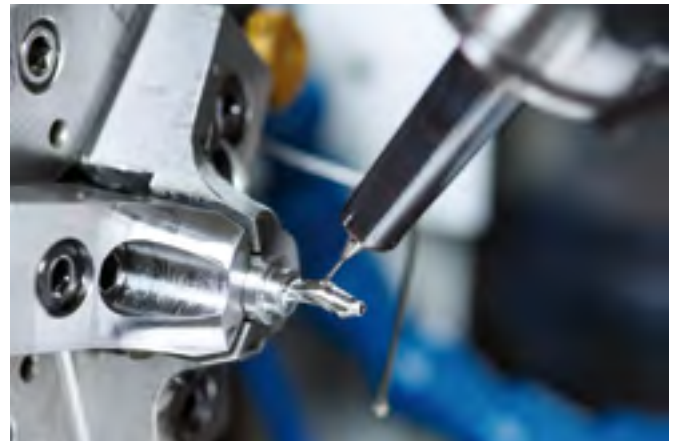
Bego Medical besitzt ein riesiges Knowhow im Bereich der computer-gestützten Fertigung. So werden neben klassischen Kronen- und Brücken- auch Implantatsuprastrukturen gefertigt
