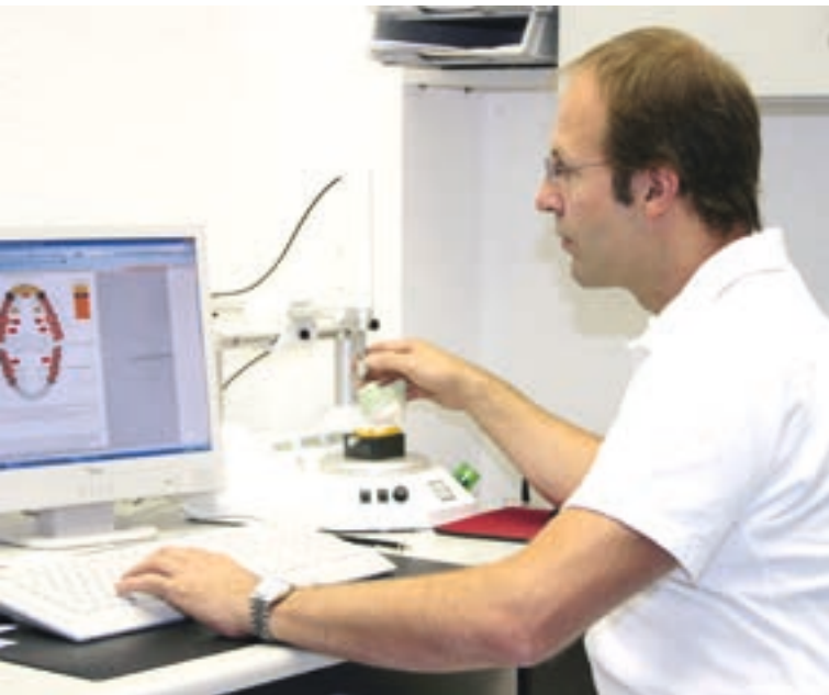
Mit dem 3D Digitizer werden die sequenziellen Führungsflächen der Zähne für jeden Patienten individuell berechnet um die optimale Okklusion zu erzielen
