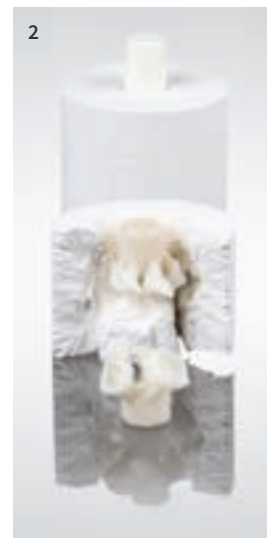
2 LiSi Press nach dem Pressen: Die nicht vorhandene beziehungsweise sehr geringe Reaktionsschicht vereinfacht das Ausbetten sowie das Abstrahlen
