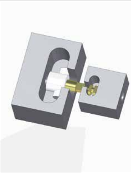
Schematische Darstellung der maßgefertigten Vorrichtung zur Zugfestigkeitsprüfung
