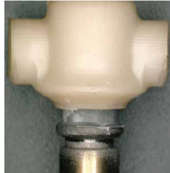
Typisches Scheitern nach der Zugfestigkeitsprüfung. Das Zirkon-Titan Hybrid-Abutment wurde dabei von der Titanbasis gelöst.
