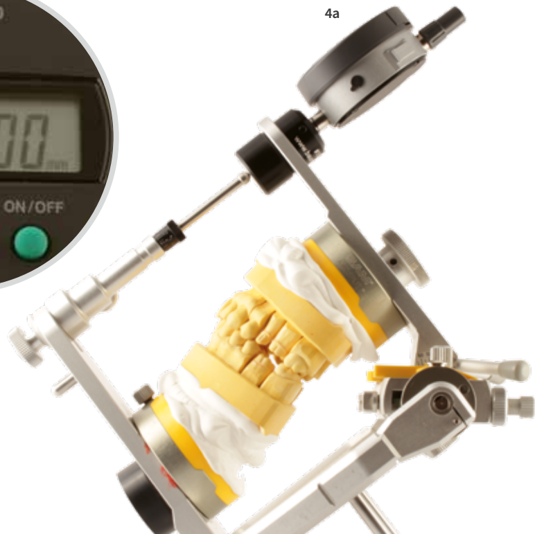
4a Adjustiert und gemessen wird grundsätzlich in gekippter Position des Artikulators. So wird das Gewicht des Artikulatoroberteils auf die Achse beziehungsweise die Kondylen des Artikulators besser verteilt.
