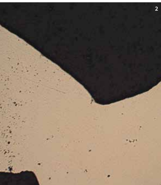
2 Gegossene Edelmetallkrone im Schliff mit Poren und Lunkern
