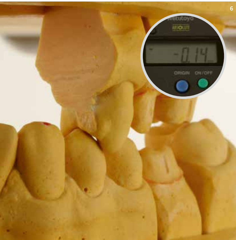
6 Es folgt das linke Prämolarencompartment. In diesem Fall der einzelne Zahn 24, weil die präparierten Zähne ausser Kontakt stehen. Der für das linke Prämolarencompartment ermittelte Wert wird wieder notiert.
