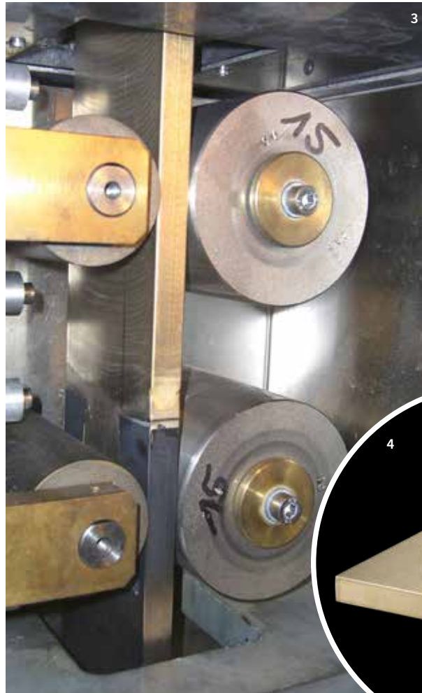
3 Edelmetallblanks werden im Strangguss gefertigt. 4 Fräsblanks aus Edelmetall
