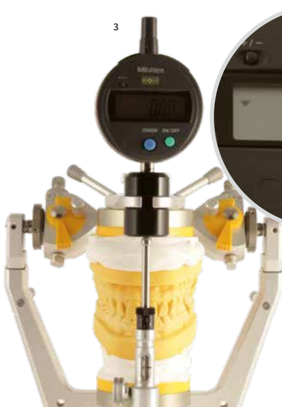
3 Der Inzisalteller des Artikulators wird nun gegen die Messuhr (hier das Okklusometer für SAM von Baumann Dental) ersetzt und diese in dieser Position auf „Null“ gesetzt.
