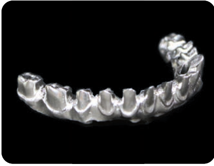
^ 09 Das Cobalt-Chrom-Gerüst nach Fertigung und Ausarbeitung
