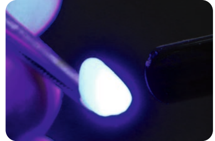
^ 17 Zwischenschritte wurden vor der Endhärtung im Lichtofen mit der Polymerisationslampe fixiert.
