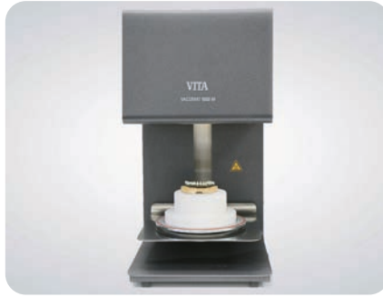
^ 19 Der Brand des keramischen Opakers erfolgte im Vita Vacumat 6000 M.
