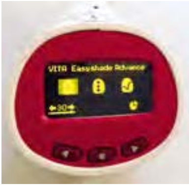
Abb. 6a Das Easyshade hat drei Messmodi: die Einzelmessung für die Bestimmung der Grundfarbe, eine Dreibereichsmessung und eine Kontrollmessung für keramische Restaurationen
