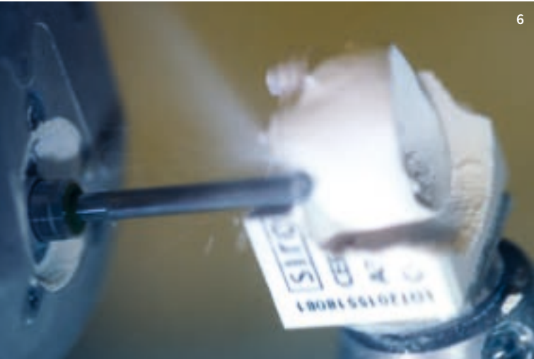
6 Trockenfräsen einer monolithischen Molarenkrone aus dem vorgesinter-ten Zirkonoxid (Cerec Zirconia) in der inLab MC XL Fräs- und Schleifeinheit
