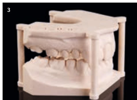
2 & 3 Die digitale Konstruktion der gewünschten Modell-Form wird mit dem Zirkozahn Softwaremodul CAD/CAM Model Maker erstellt. Die Fertigung des Modells kann dann beispielsweise mit den Zirkozahn Fräsmaschinen erfolgen
