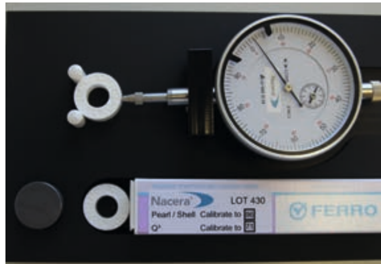
7 Nach der Sinterung wird der PTCR-Kalibrierring im Nacera Calibrate Messgerät gemessen.
