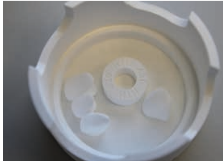
4 Der weiße, ungesinterte PTCR-Ring wird neben den zu sinternden Objekten in der Mitte der Sinterschale platziert.
