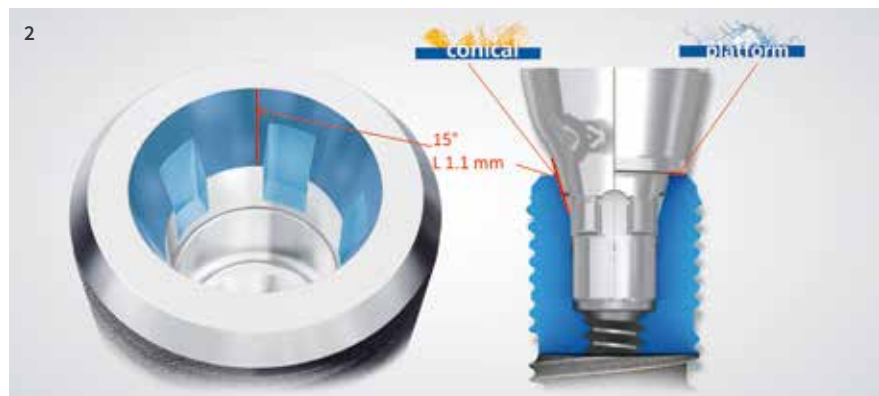
2 Anschlussgeometrien des tioLogic Twinfit-Implantats. Im Schnittbild sind links der konische und rechts der plattformbasierte Aufbau dargestellt.
