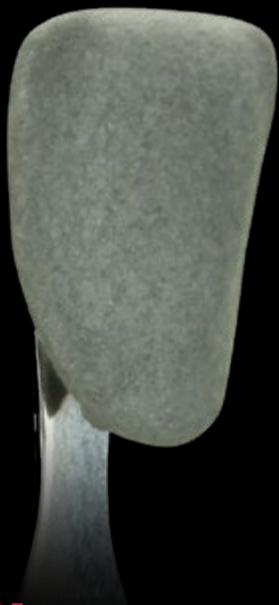
^ 35 Grundkörper für ein Farbmuster aus einer Metalllegierung. Derartige Muster kommen für individuelle Farbschlüssel für Metallkeramiken zum Einsatz.
